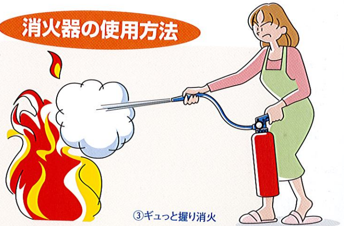
①安全栓を引き抜く ②ホースをはずし火元に向ける
